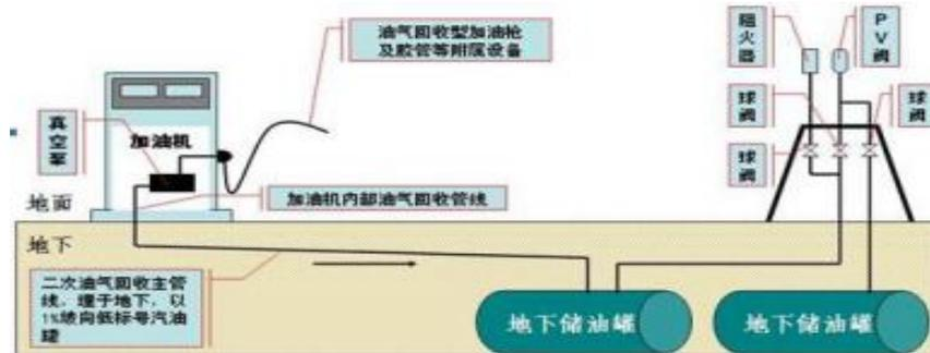
图 2.5 二次油气回收系统基本原理图
