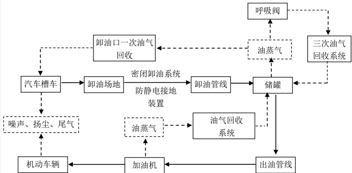
图 2.3 汽油加油工艺流程图及产污环节
