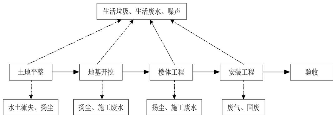
图 2.1 施工期工艺流程及产污节点
