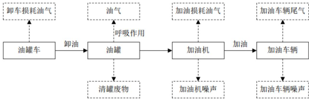
图 2.2 柴油加油工艺流程图及产污环节
