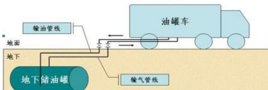
图 2.4 一次油气回收系统基本原理图
