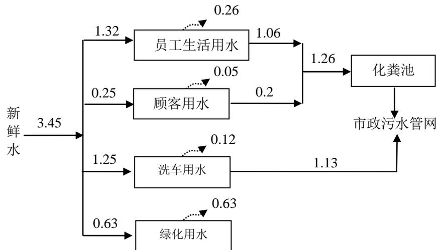
图 2.1 本项目水平衡图（单位：m<sup>3</sup>/d）
